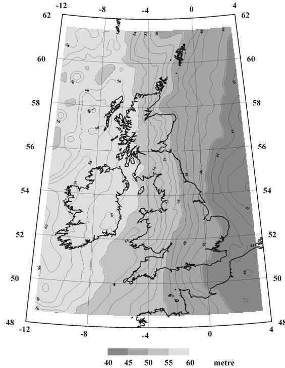
**Fig. 5.** OSGM02 gravimetric geoid. Contour interval: 1m.
